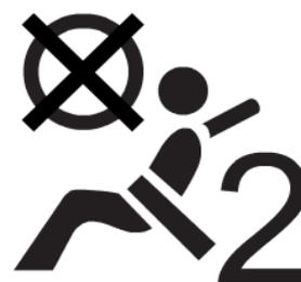
In den Sitzen auf der Fahrer- und Beifahrerseite befinden sich Sensoren welche feststellen, ob der Sitz belegt ist oder nicht. Die Lampe warnt die Insassen optisch indem sie blinkt, bis der betreffende Insasse den Gurt angelegt hat.
