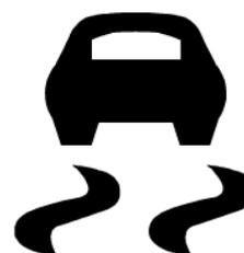
Nach dem Einschalten der Zündung brennt diese Lampe für ca. 3 Sekunden und erlischt dann. Wenn ein Fehler im VSC System festgestellt wird, so brennt die Lampe konstant.
