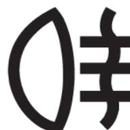
Nach dem Einschalten der Zündung brennt diese Lampe für ca. 3 Sekunden und erlischt dann. Diese Kontrollleuchte beginnt zu brennen, wenn die Traktionskontrolle aktiv ist, das heisst wenn ein Schlupf an der Vorderachse auftritt.
